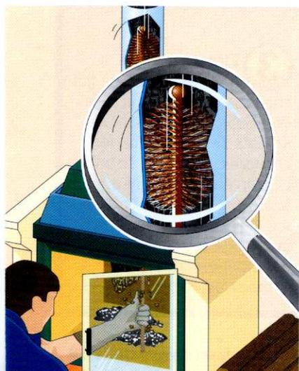
Les conduits d'évacuation des cheminées, ouvertes ou équipées d'un insert, doivent être ramonés, une fois par an, de façon mécanique, c'est-à-dire avec un « hérisson ». Cela permet de retirer les suies, les goudrons et les nids d'oiseaux. Et, ainsi, de se préserver des risques d'incendie et des émanations de gaz asphyxiants. Le ramonage par aspiration ou par produits chimiques est insuffisant.
